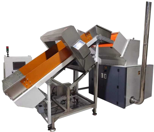
接入工厂原有负压风送系统
